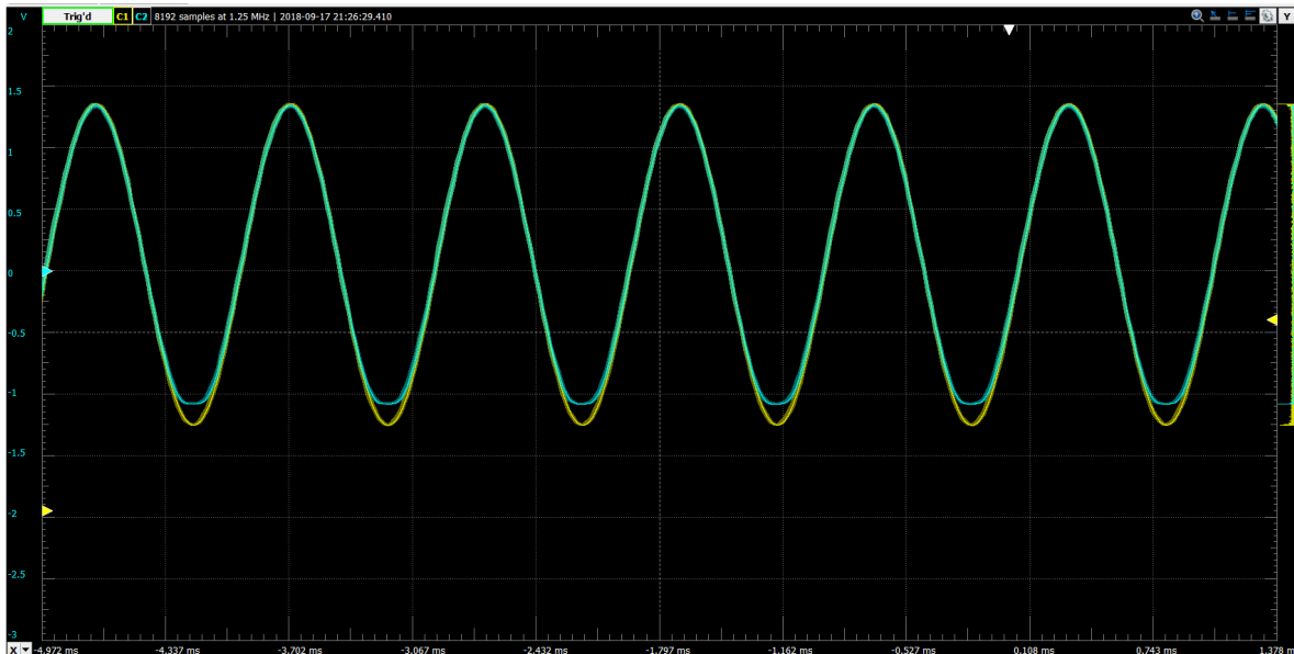
Figur 7: Utgangssignalet (blå) og inngangssignalet (gul) i det forvrengningen ble synlig.
